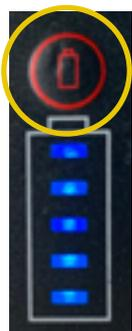
**Lorsque le display est à l'arrêt ou quand la batterie n'est pas intégrée au vélo.**
