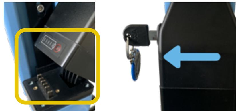
**Remarque :** lorsque la batterie est repositionnée, elle sera bloquée automatiquement par la clé.
